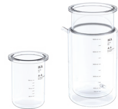
Сосуд стеклянный, одностенный, 1 л Сосуд стеклянный, двустенный, 5 л
